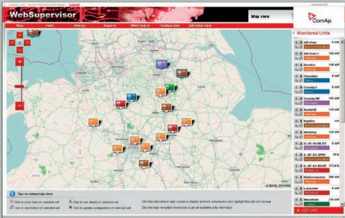
WebSupervisor 是基于云设计软件,通过因特网监测和控制 ComAp 控制器. 这个系统有多个好处可以建立你的机组群也可以对每个机组的关键参数进行监测.
